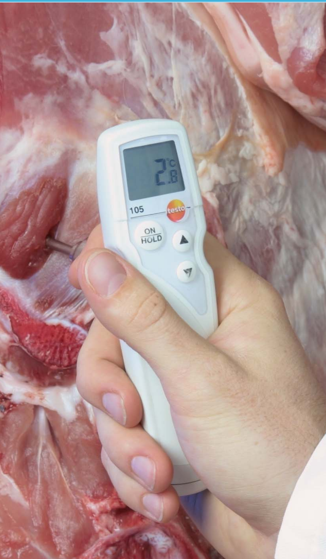
přesné měření teploty zboží při příjmu s alarmem při překročení hraničních hodnot
