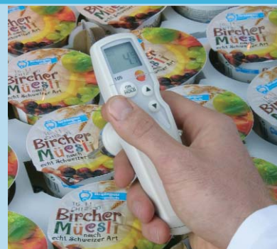
přesné měření teploty zboží při příjmu s alarmem při překročení hraničních hodnot
